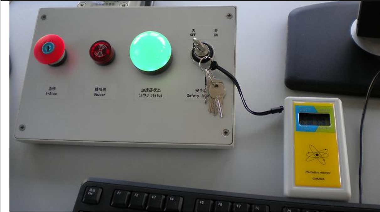
图 10-4 系统控制台上安全联锁开关
